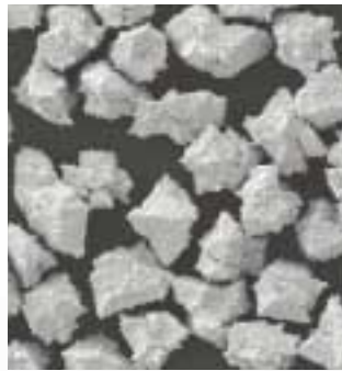
Diamante SPR N Recubrimiento con base de Ni Nivel de recubrimiento: 56 peso %
